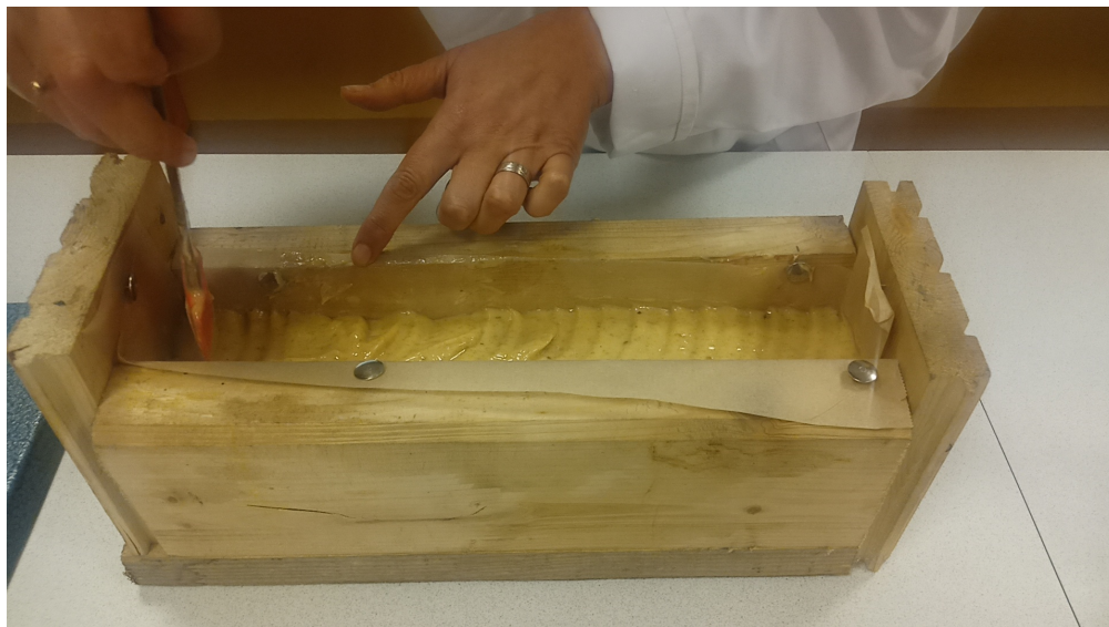
Obrázek 8: Vrstvení směsi do formy
