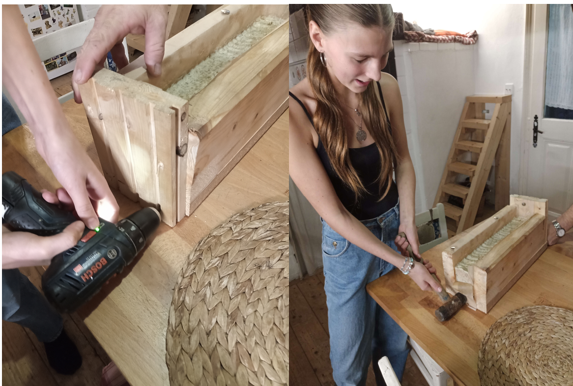
Obrázek 13: Vyjmutí z formy pomocí akuvrtáku a gumové paličky
