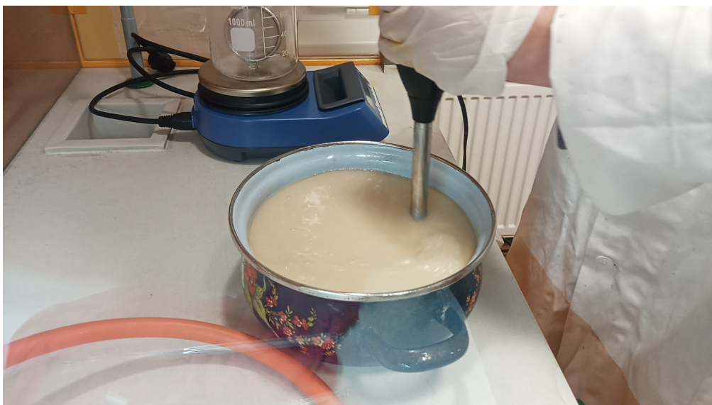
Obrázek 7: Smíchání směsi a roztoku tyčovým mixérem
