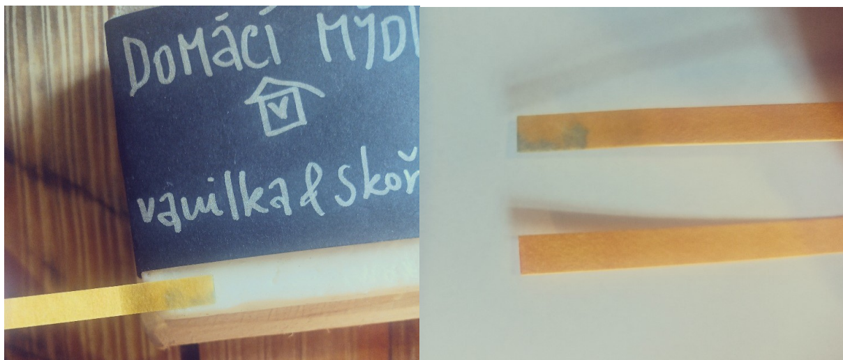
Obrázek 17: Kontrola pH hodnoty indikátorovým papírkem u mýdla VANILKA&SKOŘICE
