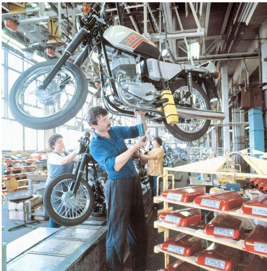
Obrázek č. 11 Výroba motocyklu Jawa 350 typ 638
