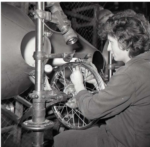
Obrázek č. 9 Výroba Jawy 50/05 (na snímku vlevo centrování kol) v Povážské Bystrici
