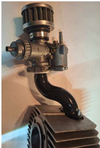
obr. 31 test karburátoru z jawa 90
