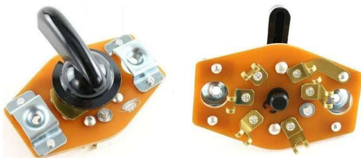
obr. 14 přepínací skříňka, pohled na kontakty
